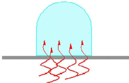
Cuando la gota cae y entra en contacto con la superficie caliente del sartén, una gran cantidad de calor es transmitido en un corto tiempo a través de una amplia superficie de contacto, impidiendo que se caliente todo el volumen de agua de la gota en forma uniforme y produciendo por lo tanto la brusca evaporación en la porción que entró en contacto con la sartén.
