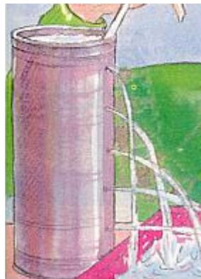
En algunos libros de texto para ilustrar como varía la presión con la profundidad en el interior de un líquido se utiliza el experimento que se ve en la figura. El razonamiento es el siguiente:
