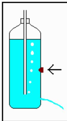
En la figura se ve una botella que se vacía a través de un orificio que tiene cerca de su base. El tapón está atravesado por un tubo hueco. ¿Qué sucederá al quitar el corcho que tiene en el lateral? ¿Saldrá agua por los dos agujeros?
