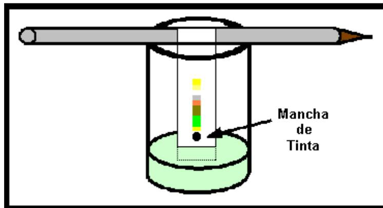
Los biólogos, médicos y químicos necesitan con frecuencia separar los componentes de una mezcla como paso previo a su identificación. La cromatografía es una técnica de separación de sustancias que se basa en las diferentes velocidades con que se mueve cada una de ellas a través de un medio poroso arrastradas por un disolvente en movimiento. Vamos a utilizar esta técnica para separar los pigmentos utilizados en una tinta comercial.
