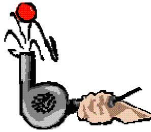
Si colocamos con cuidado una pequeña pelota, de poco peso, encima de un secador de pelo, como se ve en la figura, observaremos que se mantiene flotando sobre el chorro de aire. Es capaz de soportar incluso pequeños empujones laterales. Observaríamos un comportamiento similar si colocásemos la pelota sobre un chorro de agua vertical. ¿Cuál es la explicación de este curioso comportamiento?
